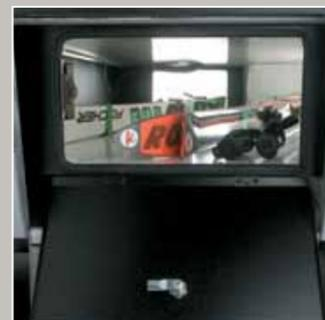
**Maxi gavone.** Grande capacità di stivaggio nel maxi-gavone sottopavimento, accessibile da entrambi i lati con altezza utile fino a 25 cm, illuminato e con un volume di carico fino a 780 Lt.
